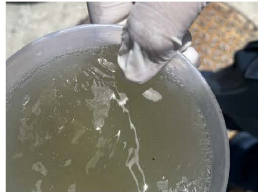
การเก็บตัวอย่างน้ำทิ้งออกจากระบบบำบัดน้ำเสีย
